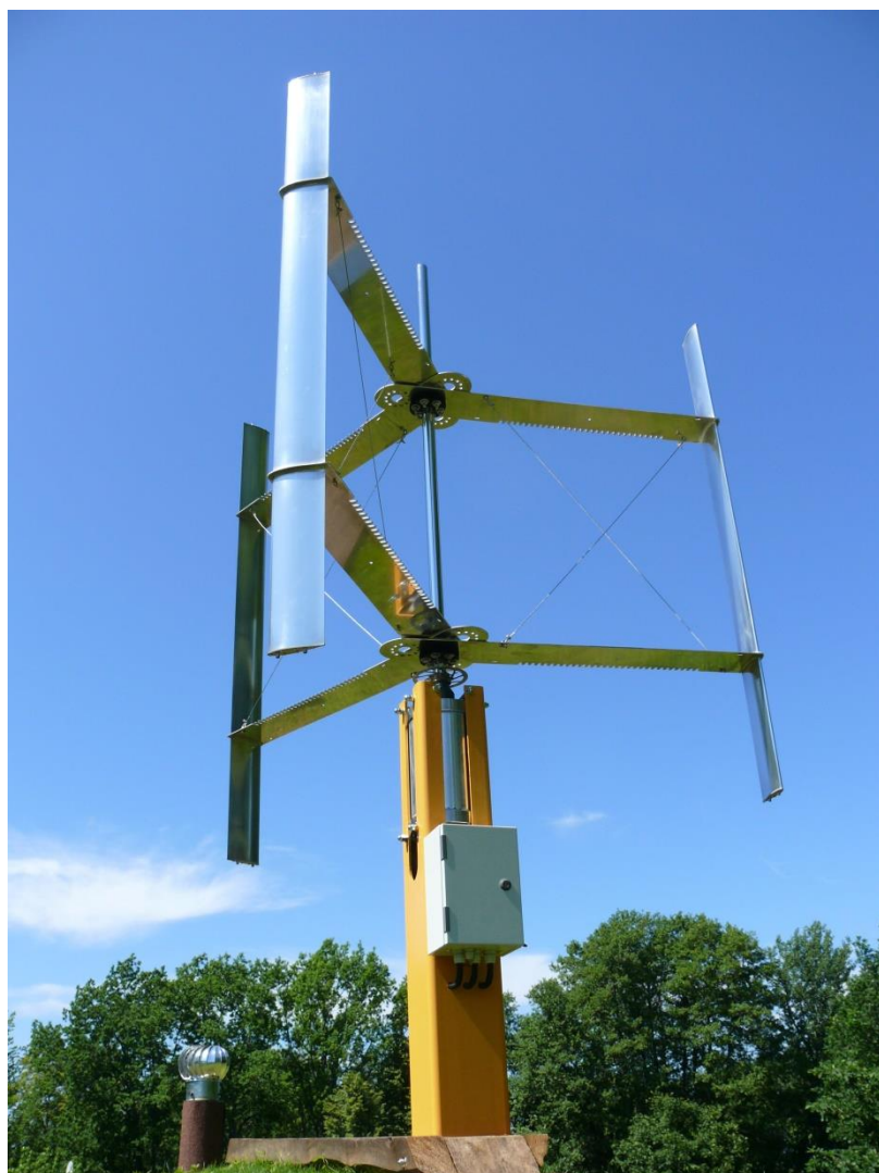
Joonis 2 Väljavõte TT 2013.a. taotlusest, alumiiniumist vertikaaltuuliku katseeksemplar
